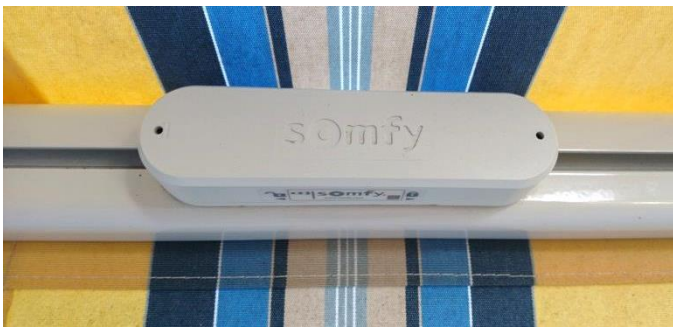
Le capteur est clipsé sur la platine de fixation
